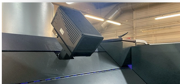
Technologie QualiTronic PrintCheck (caméra de contrôle en ligne qui scanne chaque feuille).
